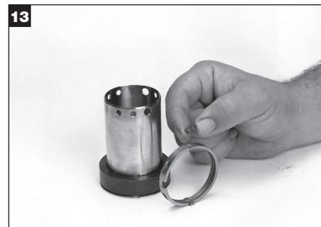
Si aún no están instaladas, instale las dos grapas de arrastre en las ranuras del canal de flujo. Nota: Para los tamaños mayores de 60 mm (2,50 pulgadas) hay cuatro grapas de arrastre.
