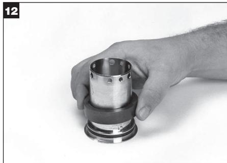
Lubrique al aro tórico (O-Ring) del diámetro interior de la camisa con la grasa de silicona suministrada e instálelo en la ranura del diámetro interior de la camisa. Lubrique el aro tórico de la rotativa de la camisa e instálelo en la ranura del diámetro exterior de la camisa. Deslice el anillo del sello rotativo sobre la camisa, hasta el fondo alineando las orejas de arrastre de la camisa con las ranuras del anillo del sello rotativo.
