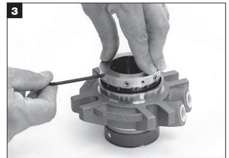
Presionando hacia abajo por el anillo de fijación, retroceda todos los tornillos prisioneros hasta que se desenganchen de la camisa.
