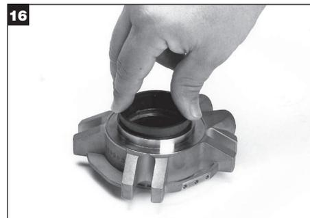
Voltee el conjunto de la brida. Empuje la otra estacionaria dentro del lado interno de la brida, empujando con cuidado para pasar por el aro tórico, hasta que enganche con las grapas de arrastre sobre el canal de flujo. Verifique que las grapas de arrastre estén alineadas con las ranuras de la estacionaria. Este conjunto debe poder moverse (axialmente) con facilidad.
