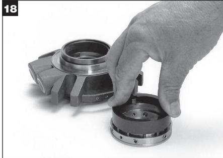
Deslice el anillo del sello rotativo externo sobre el anillo de fijación hasta que quede sobre el aro tórico (O-Ring), alineando las orejas de arrastre con las ranuras de la rotativa. Presione por el anillo del sello rotativo para comprimir los resortes y asegurarse de que el anillo del sello rotativo se puede mover libremente. Limpie las caras de los anillos de la estacionaria y rotativa con un paño sin pelusas.
